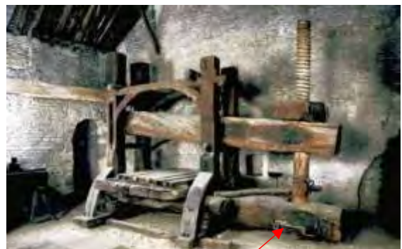
Brebis : poutre inférieure de la presse
